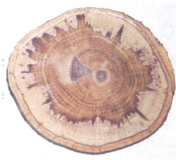
被害材の木口面
